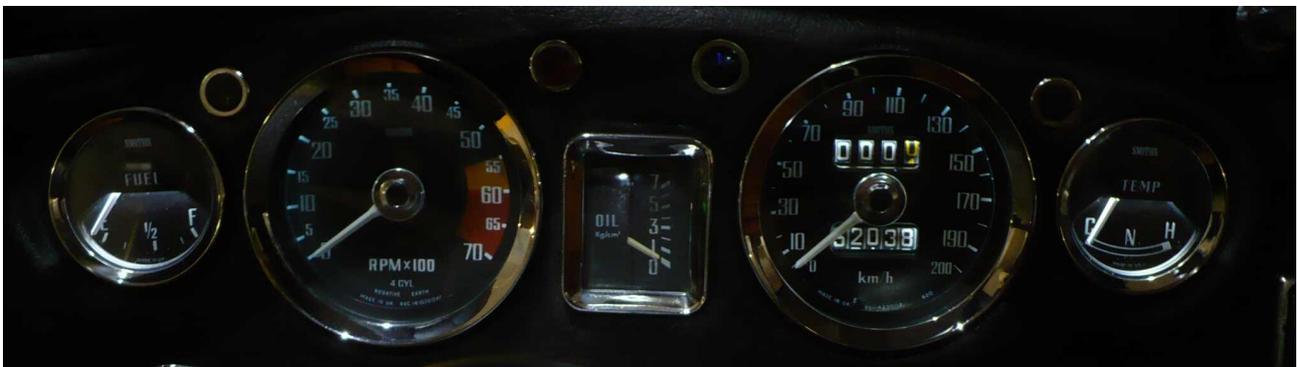
Neuerdings gibt es auch eine einfache Umrüstmöglichkeit durch Ersatz der E10 Glühlampen durch eine kompatible LED Birne. Vor allem für die kleinen Instrumente dürfte das genügen. Die Öldruckanzeige im obigen Bild ist so ausgerüstet.
