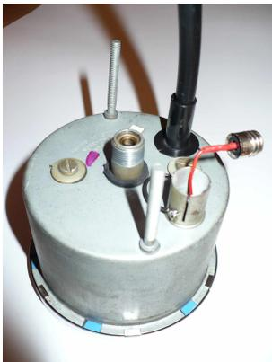
Die zwei Befestigungsschrauben auf der Rückseite werden entfernt und die Tachomechanik vorsichtig nach vorne ausgebaut werden.
