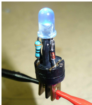
Oben sieht man die verwendete blaue LED (Polarität beachten), links den Vorwiderstand und rechts die Sperrdiode. Für Interessierte: Sperrdiode 1N4148 Vorwiderstand 390R/0.4W LED 5mm blau diffus Kingbright L-7113MBDK Strom: 20mA
