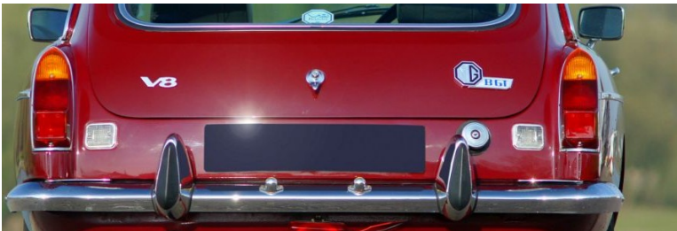
MGB Tail 1974 Chrom Bumper with Rubber Als einziger Jahrgang Nummernschild-Lichter auf der Stosstange
