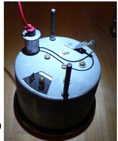
getrennt werden. Natürlich kann die Lampenfassung abgeschnitten werden und die Verbindung anderswie hergestellt werden. Wichtig ist aber eine einfache Lösbarkeit und Isolation gegen Masseschluss. Bevor das Messwerk eingebaut wird, empfiehlt sich eine kurze Kontrolle der Beleuchtung. Dazu kann auch eine kleine 9V Blockbatterie dienen (Polarität beachten).
