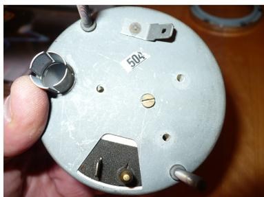
Auf der Rückseite sind 3 der 4 Messingschrauben zu lösen.
