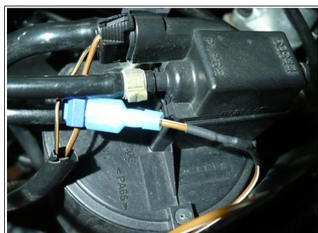
welche in einem handelsüblichen Kleingehäuse Platz findet. Der Sensor (Reed-Switch) im neuen Expansionsgefäss verbindet die Schaltung mit dem Zündungsplus. Für ein Zündungsplus im Motorraum bietet sich ein Anschluss beim Aktivkohlefilter (NK) an. Mit einem steckbaren "Stromdieb" kann dies ohne Trennung der Litze geschehen.
